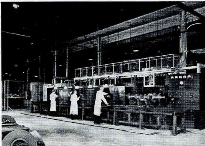
Fig. 49. — Trempe de vilebrequins. Tunnel à 5 postes. GA de 450 kW.
