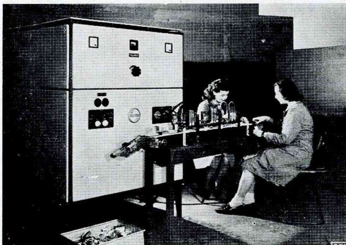
Fig. 86. — Brasage à l'étain de boîtiers. GE de 6 kW.
